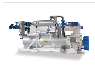
Toevoerschroef en geïsoleerde Conditioner met stoomset voor bovenop de expander
